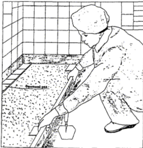
Рисунок 15 - Разравнивание раствора рейкой по маякам
