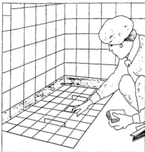
Рисунок 17 - Укладка плитки в ячейки шаблона
